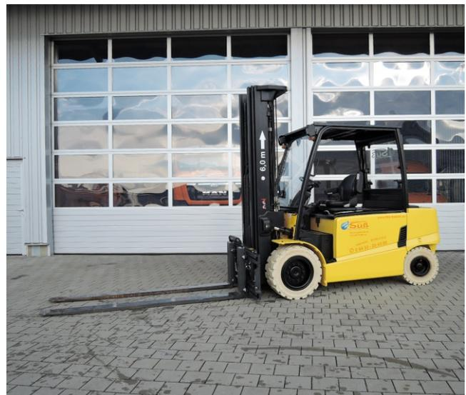
\* (4250 kg bei 0,5 m LSP, bis 4,3 m Hub, siehe Diagramm)
